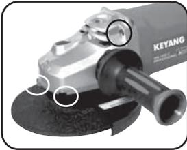
Veillez à ce que les vis de chaque côté soient serrées fermement. Resserrez les vis desserrées. Les vis desserrées représentent un danger.
